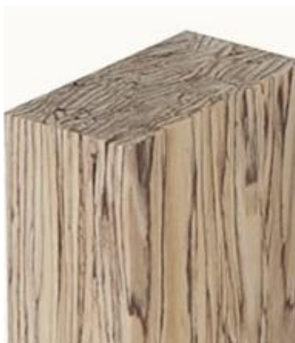
Fig. 87. Madera de chapas paralelas PSL de abeto fabricada en Canadá. Fuente: https://cutt.ly/ymuxCOT
