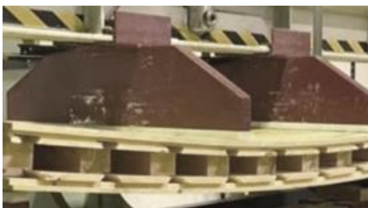
Fig. 97. Prueba experimental del estudio de flexión de los paneles TTP. Fuente: (Baño & Moltini, 2021, p. 4).
