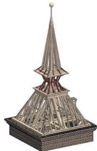
Fig. 29. Armadura del chapitel de Daganzo. Fuente: Pilar y Luia Meyer (1989).
