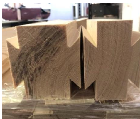
Fig. 98. Fotografía del conector de cola de milano durante el proceso de fabricación del TTP. Fuente: (Baño & Moltini, 2021, p. 3).
