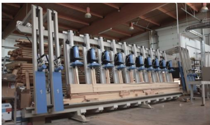
Fig. 72. Prensado vertical de GLT en las instalaciones de Cesefor. Fuente: Cesefor.
