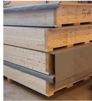
Fig. 81. Fotografía del forjado en taller de la Torre Mjøstårnet, Noruega. Fuente: https://cutt.ly/fmyKyuc
