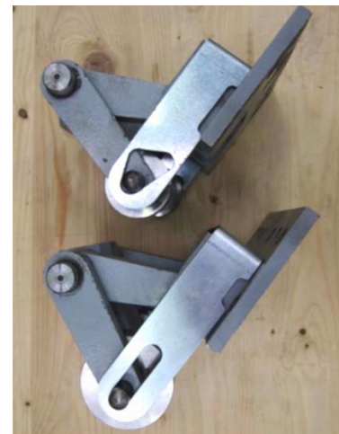
Fig. 100. Mecanismo de autotesado en diferentes configuraciones geométricas. Fuente: (Suárez, et al., 2017).
