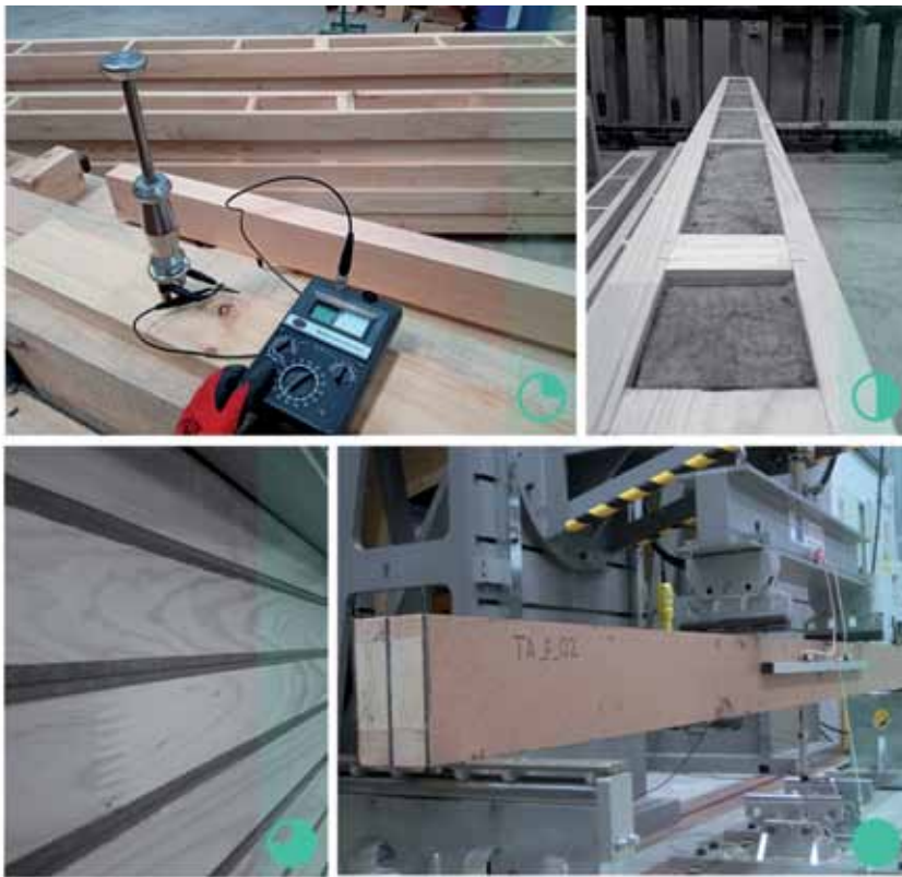
Proceso: 1 Selección de la madera 2 Montaje de células ETC 3 Acabado final 4 Ensayos de control de calidad en el laboratorio de la Plataforma de Ingeniería de la Madera Estructural (PEMADE).
