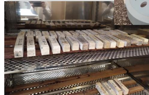
Determinación humedad mediante secado en estufa (UNE 13183-1)
