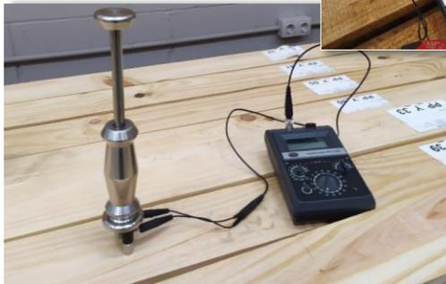
Determinación humedad mediante xilohigrómetro (UNE-EN 13183-2)
