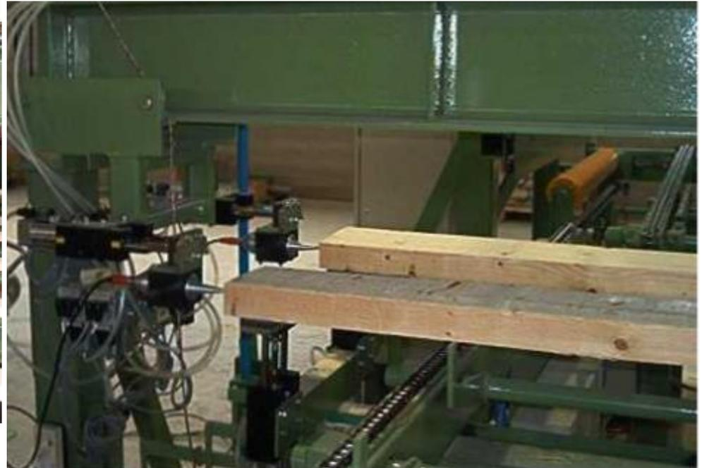
Puede medir (velocidad de propagación de ondas ultrasónicas, humedad y densidad) 40 piezas de 15 m de longitud por minuto. Este equipo (Triomatic – CBT - Sylvatest) está homologado según la norma EN 14081-4 (maquinaria para clasificación estructural de madera) y configurada para indicar la clase resistente para algunas especies (EN 338) por ultrasonido
