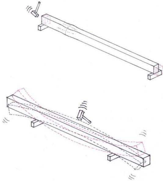
Se hace vibrar el material con el pulso aplicado directamente en la pieza
