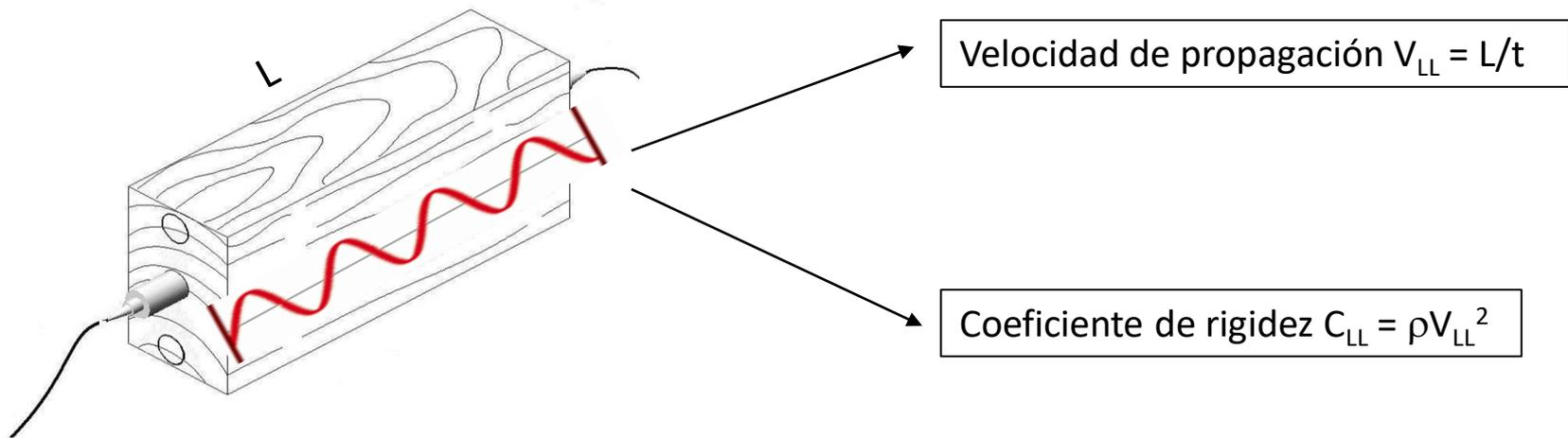
Al propagarse a través del material hay un transporte de energía y la velocidad depende de la elasticidad del medio
