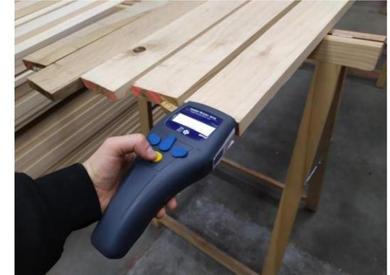
Con esta frecuencia de vibración ( $f$ ) se calcula el módulo de elasticidad
