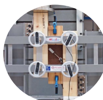
Cortante de cizalladura
