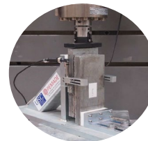
Cortante de rodadura
