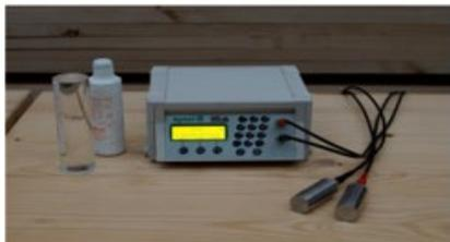
Para el análisis de vibraciones (MTG y PLG) se miden la frecuencia natural de vibración de la madera para estimar sus propiedades resistentes. La velocidad de vibración se calcula asociando la frecuencia ( $f$ ) a la longitud ( $L$ ) de las tablas.
