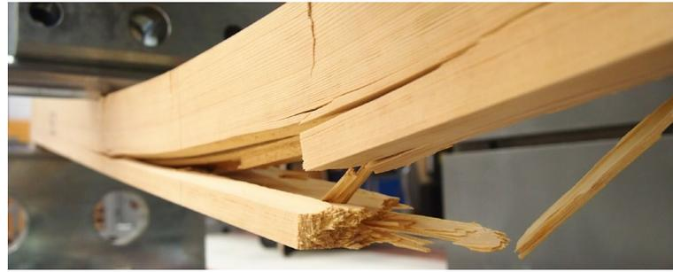
Con el fin de obtener los parámetros resistentes del material, se llevan a cabo ensayos normalizados. La norma **UNE-EN 408: 2011+A1** establece la metodología a seguir para caracterizar mecánicamente la madera aserrada y madera laminada encolada para uso estructural.
